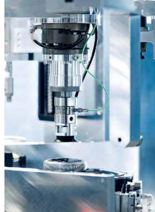
Vertikale Druckkraftmessung mit piezoelektrischem Kraftsensor Typ 9311
